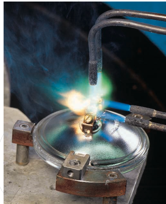
Gas/Sauerstoff-Flamme bringt die Glaskolben-Hülse-Lötverbindung zu einer Liquidustemperatur des Lotes von 783°C.
