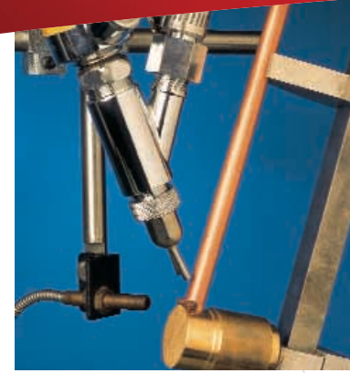
Auf Vorschubeinheit montierte Dosierpistole bringt Fusion Lotpaste an die Lötfläche des Werkstücks an.
