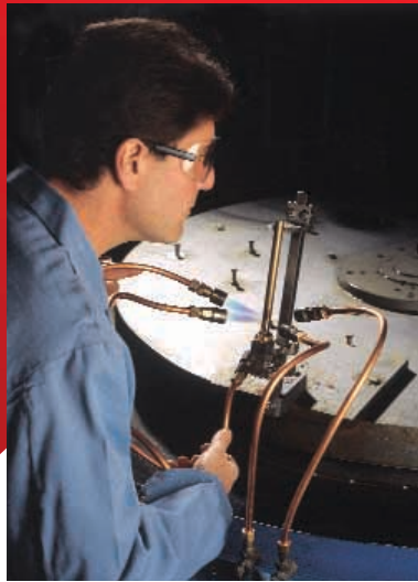
Prototyp-Vorrichtung auf einer Labormaschine zum Determinieren der Anwendungsmethode, Wärmeverteilung und machbaren Produktionsrate.
