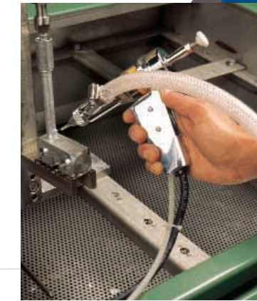
Handheld Dosierpistole bringt automatisch Lotpaste als Punkt- oder Streifenform an.
