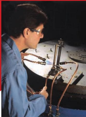
Se monta herramienta prototipo en una máquina de laboratorio para determinar el método de aplicación de pasta, el patrón de calentamiento y el ritmo de producción alcanzable.
