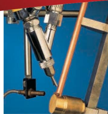
La pistola aplicadora montada en un deslizador deposita Aleación en Pasta Fusion al área de unión.
