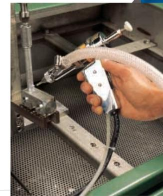
La pistola aplicadora de sujeción manual aplica pasta automáticamente en forma de depósitos de punto o ralla.
