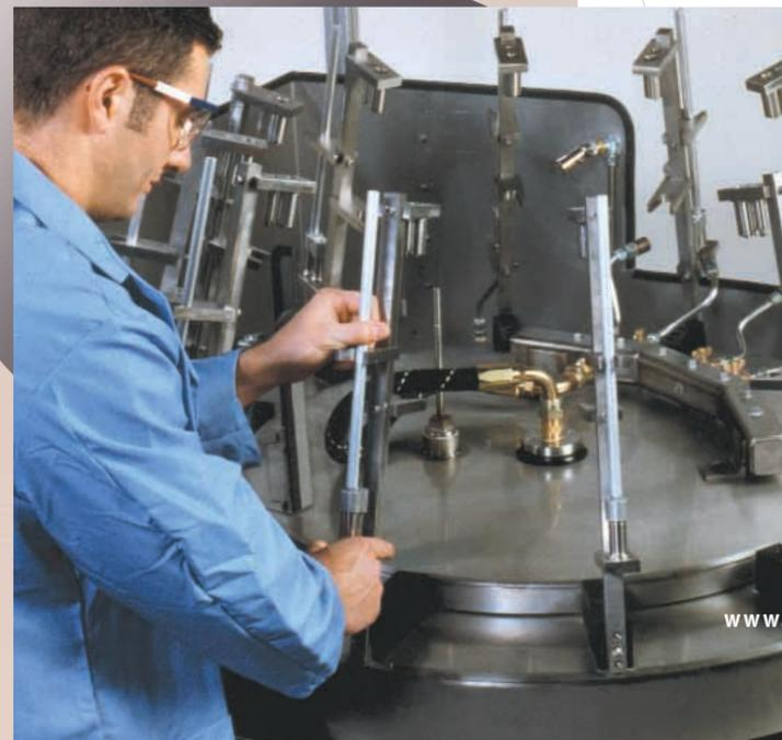
Los Dispensadores Automáticos aplican depósitos precisos de Aleación en Pasta Fusion a tubos de cobre.
