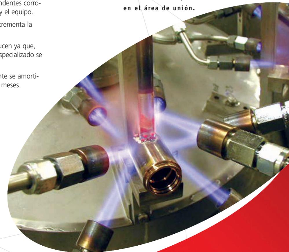
El patrón de calentamiento preciso distribuye correctamente el material de aporte en el área de unión.
