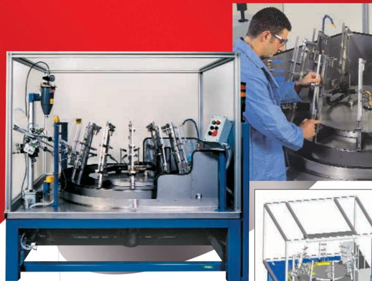
Una máquina rotativa transporta partes montadas en herramienta a través de la aplicación de la aleación de soldado, el calentamiento y el enfriamiento.
