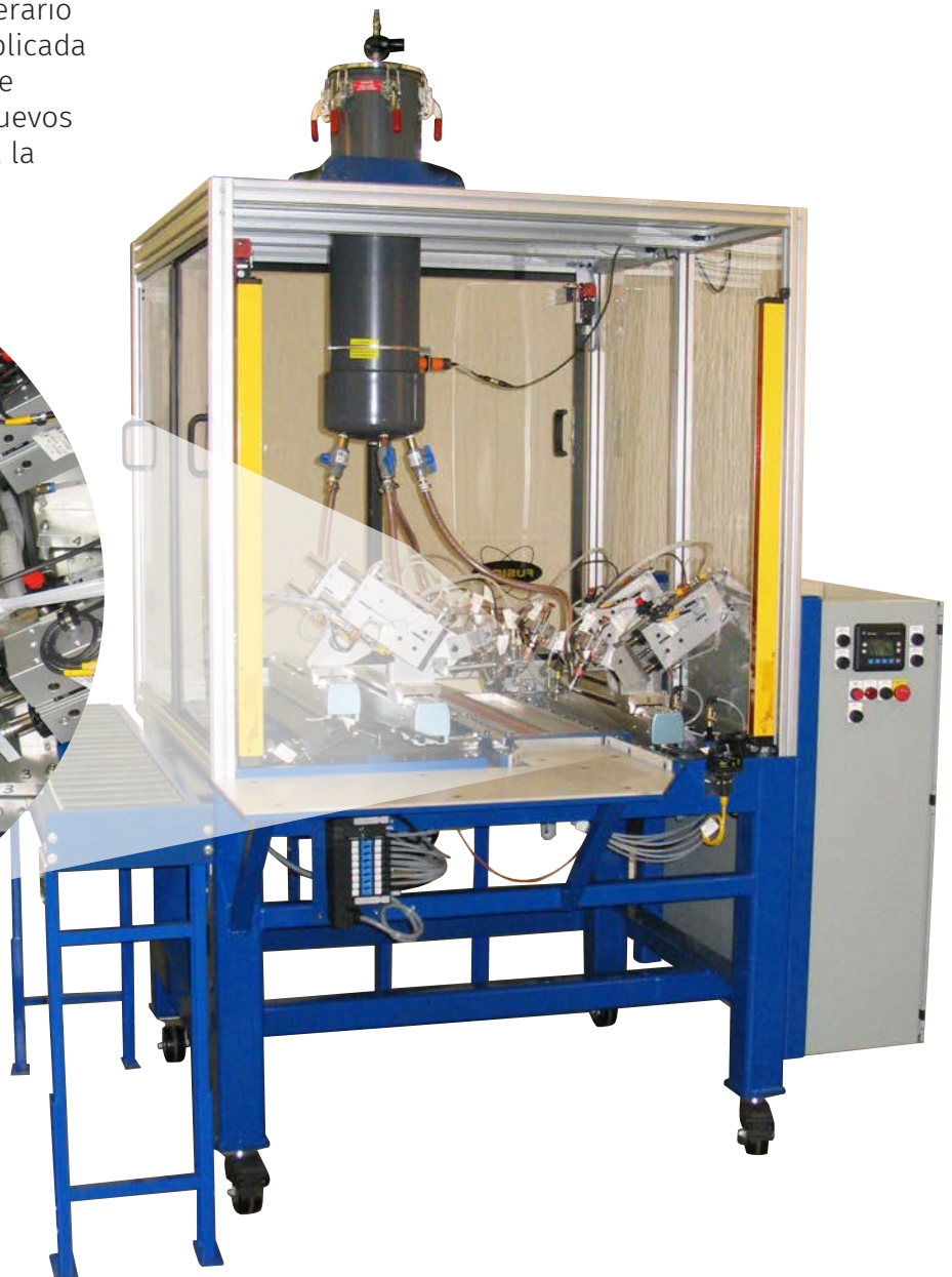
Los Robots equipados de Pistolas dosificadoras depositan la pasta de cobre para la soldadura de los tubos con una cadencia de 6.200 soldaduras por hora. Después de la dosificación de la pasta, las piezas se cargan en un horno con atmosfera controlada
