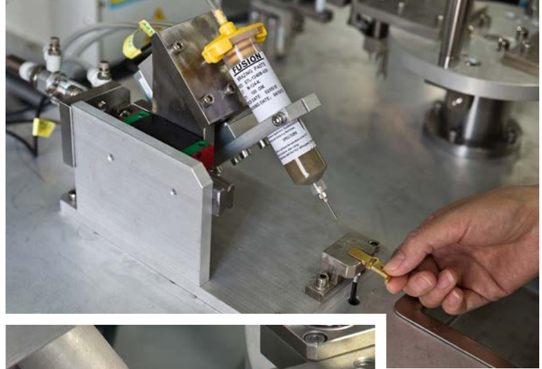
Pasta d'argento erogata dalla cartuccia sulla base del contatto elettrico prima del riscaldamento a induzione.
