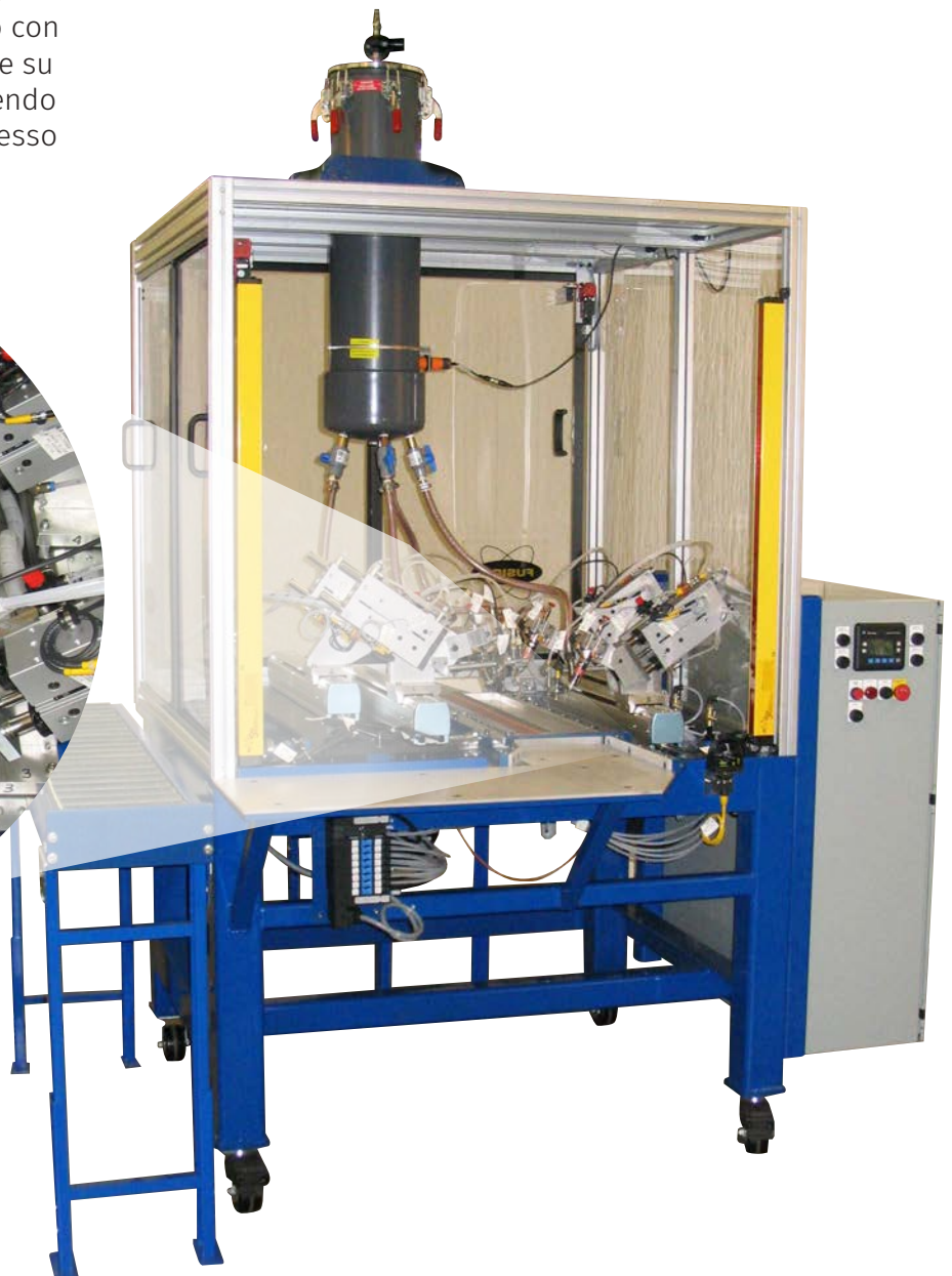
I robot a singolo asse gestiscono le pistole del dosatore per erogare la pasta di rame ai giunti tubo/raccordo con una produttività di 6.200 pezzi all'ora. Dopo aver dosato la pasta, le parti vengono caricate in un forno per brasatura in atmosfera.
