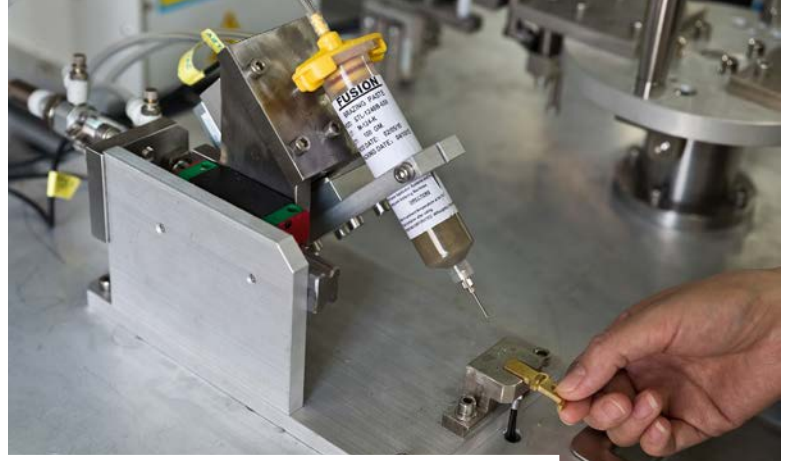
Pâte argent déposée par cartouche sur une base de contact électrique avant la chauffe par induction.
