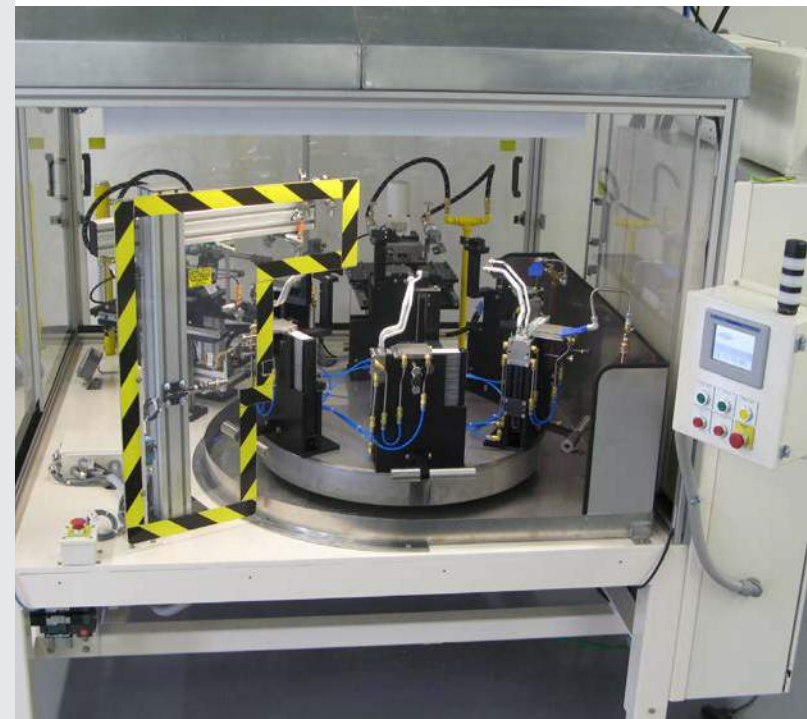
转盘机将固定好的工件传送到焊膏下料工位、加热工位和冷却工位的操作顺序。
