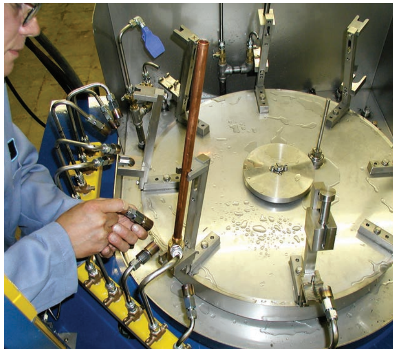
Top: 在实验室机器上安装用于验证的原型夹具和装置，以确定焊膏的施涂方式、加热方式，以及可以实现的产能。 Middle: 可行性试验阶段的参数被运用到最终的机器设计中，以实现客户对硬钎焊/软钎焊工件的技术规范要求。 Bottom: 福星技术服务人员在客户工厂里提供现场服务，指导安装硬钎焊机器和培训操作人员。
