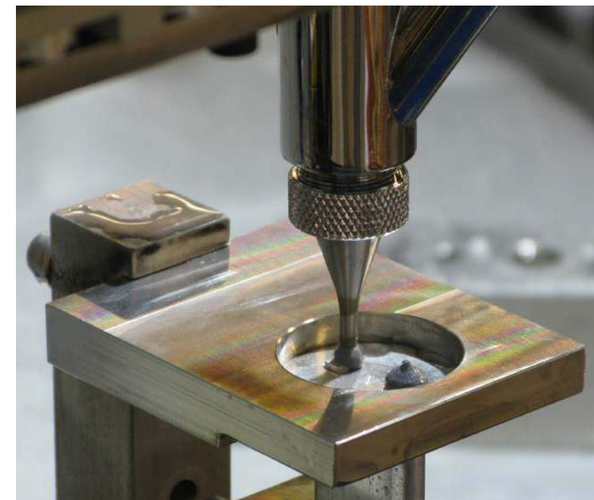
Top, Right: 福星标准型机台的设计，基于一名操作工人工手动装工件和卸工件 Middle, Right: 精确的加热模式保证了焊膏填料金属均匀铺展至整个焊接区域。Bottom, Right: 福星自动下料器将定量的福星合金焊膏施涂到铅质焊点上。
